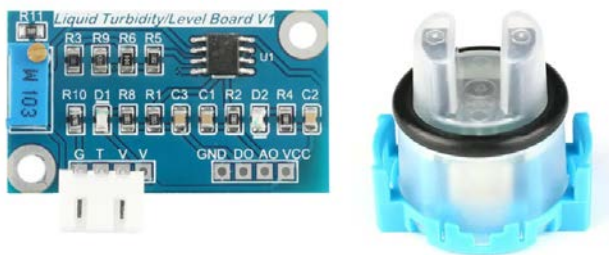
Рис. 1. Зовнішній вигляд електронного модуля TS-300B та сенсора каламутності TSW-30
